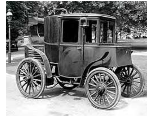
Riker Electric um 1900 mit 4 Radnabenmotoren
